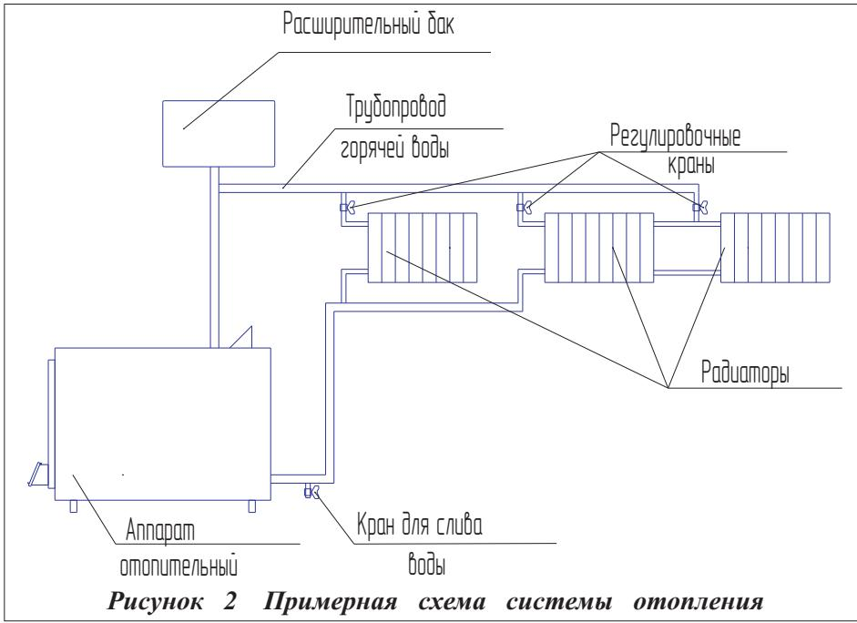
**Рисунок 2 Примерная схема системы отопления**
