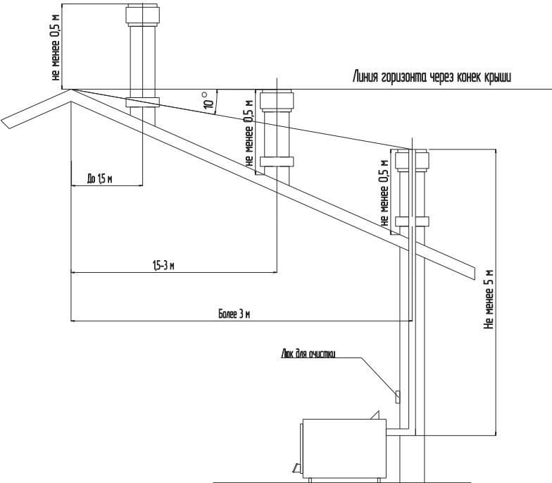
**Рисунок 3 Варианты установки дымовой трубы**
